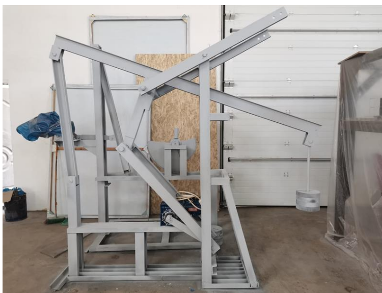
18-сурет- Алты буынды түзу сызықты бағыттаушы түрлендіргіш жетек механизмінің эксперименттік үлгісі
